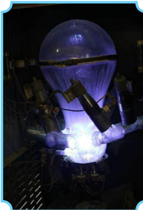
3 වන රූපය - බොහෝ විට ලොව අවසාන සක්‍රීය රසදිය වාප සෘජුකාරකය, ජෙරාදෙණිය විශ්වවිද්‍යාලයේ විදුලි හා විද්‍යුත් ඉංජිනේරු අංශයේ සිසුන්ට තවමත් සේවය කරයි.
