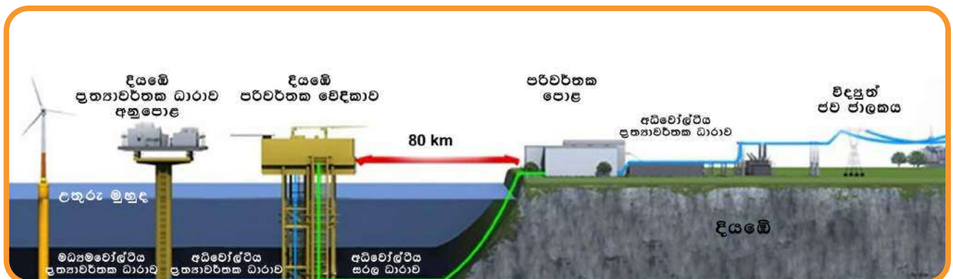
6 වන රූපය : වෙරළට ඔබ්බෙන් පිහිටි සුළං බලාගාරයක සරල ධාරා සම්බන්ධතාව
