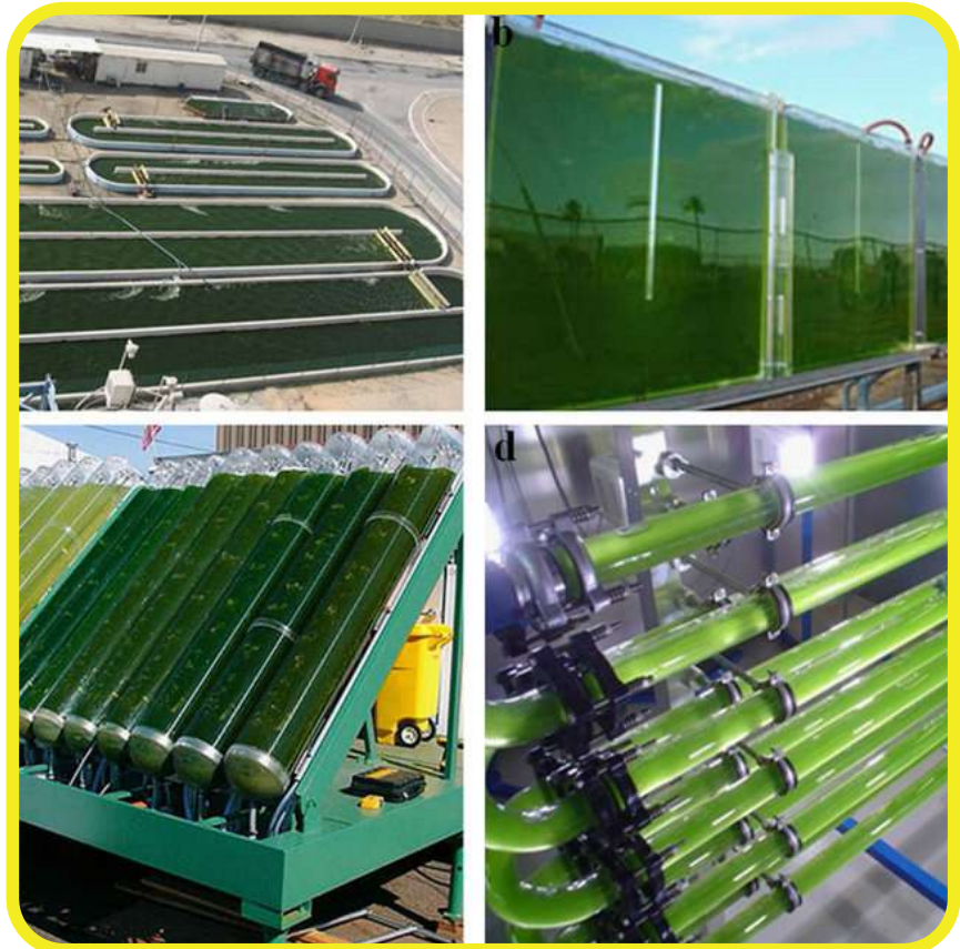
රූපය 5: පිටත සිදුකරන ක්ෂුද්‍ර ඇල්ගී වගා ක්‍රම (ආශ්‍රිතය: Bitog et al., Application of computational fluid dynamics for modeling and designing photobioreactors for microalgae production: A review, Computers and Electronics in Agriculture 76, 2011)
